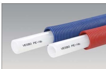
Şap altından yürütülerek radyatöre bağlanan borular, koruyucu nitelikte olan ve aynı zamanda hava yastığı görevi yapan koruyucu kılıf içinden geçirilirler. Kırmızı renkli kılıf borular radyatöre gidiş hattında, mavi renkli olan kılıf borular ise çıkış hattında kullanılır.
